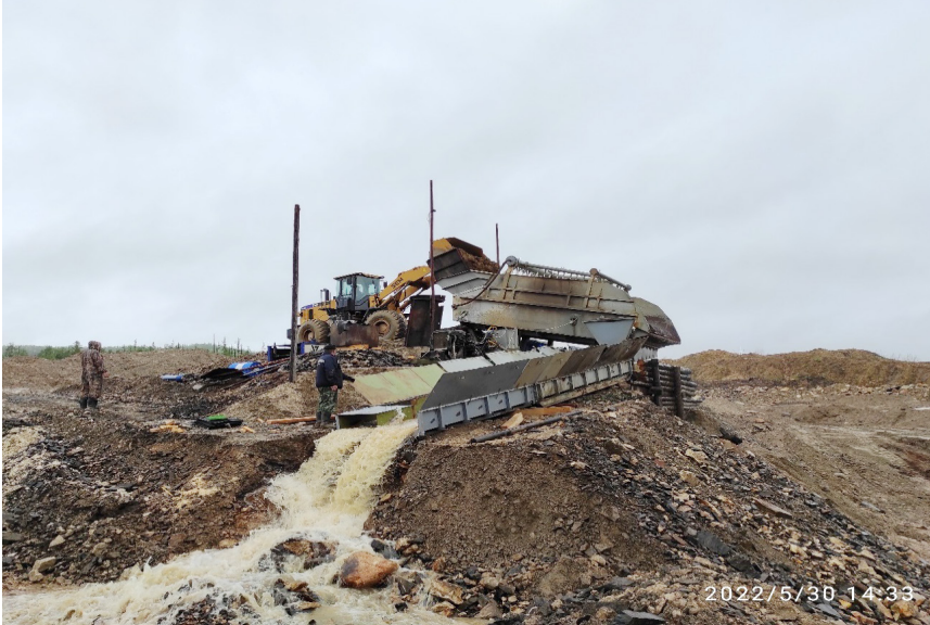
Рис. 23. Погрузка колесным погрузчиком песков на промывочный прибор ГПП 1500.
