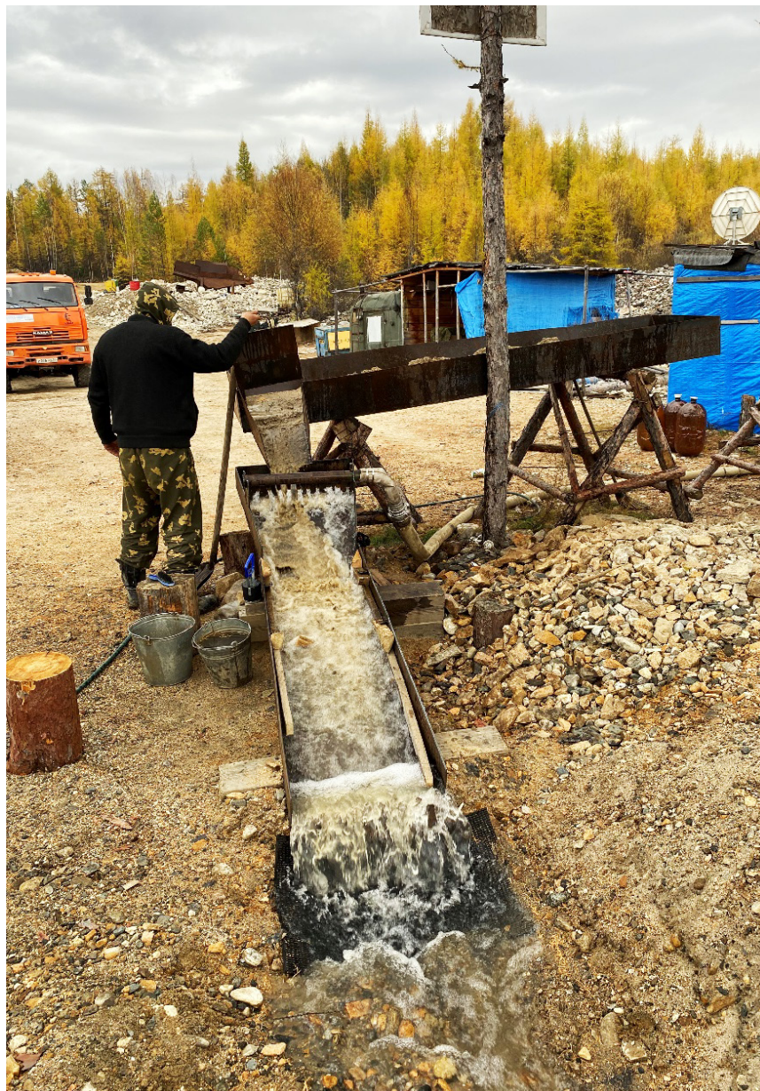
Рис. 24. Обогащение песков с колоды на проходнушке
