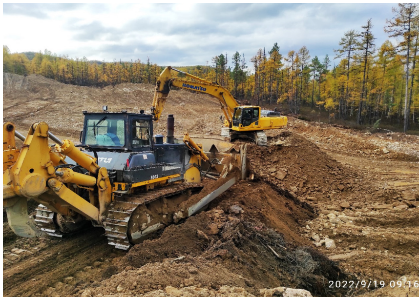
Рис. 21. Вскрыши и разработка россыти Правой террасы р. Талга
